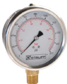
Figura 4.19 Manómetro STAUFF, configuración Stem, tipo de conexión tipo S, con tipo de casco SGP (Stainless-Steel). Dial de 63 mm. Modelo 02000. Sin accesorios, dial en BAR Y PSI.
